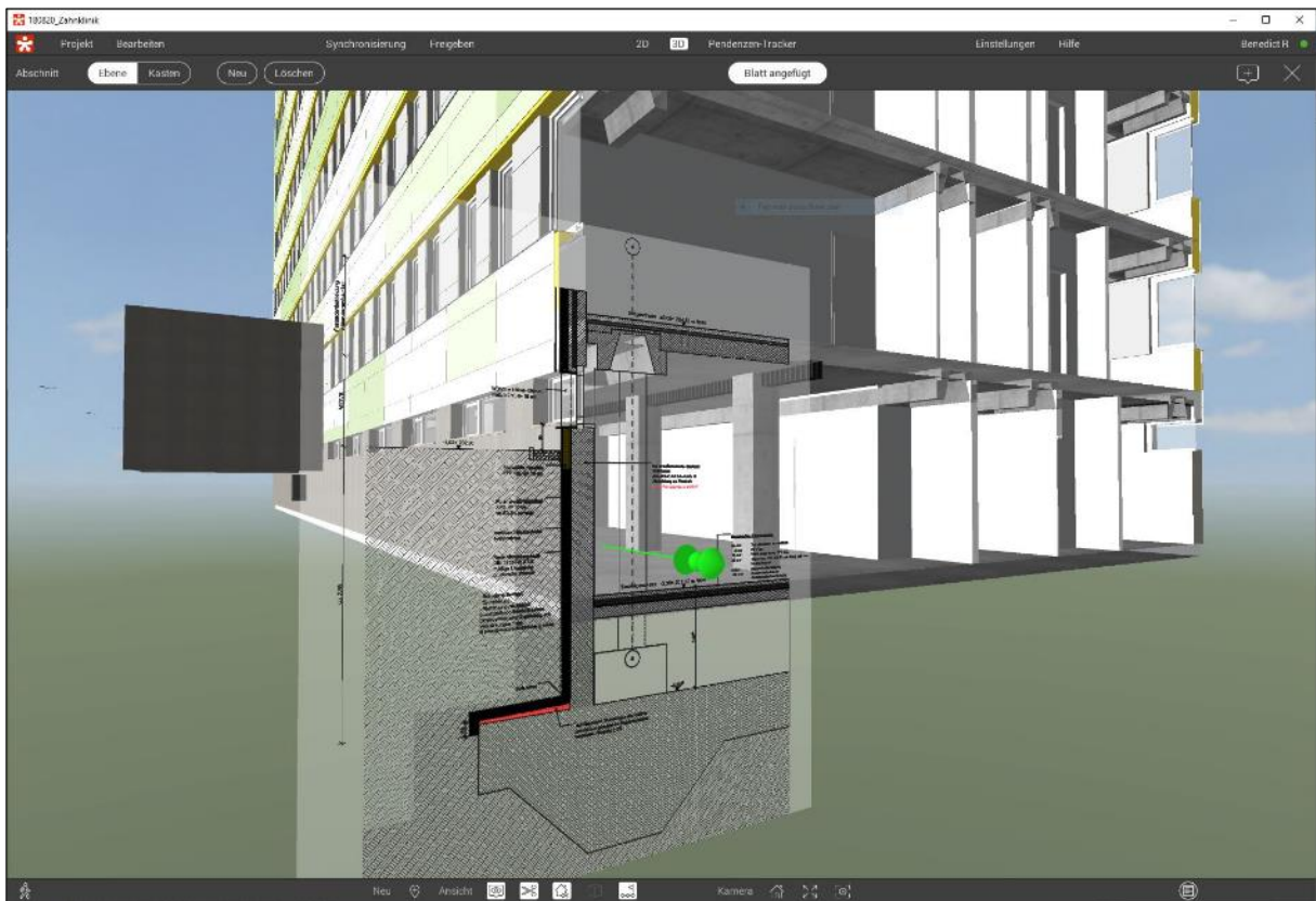
Abbildung 12 Überlagerung eines Gebäudemodells mit Plandokumentation in Revit. Quelle: Eigene Darstellung/ baukonsult-knabe / Revit
