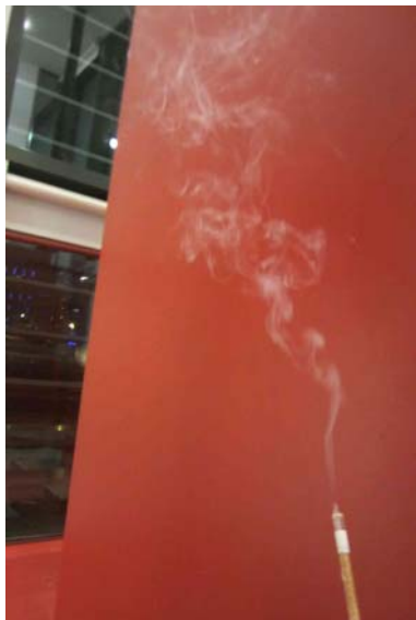
Bild 8: Auftriebsströmung im Treppenhaus auf der Wohnraumseite
