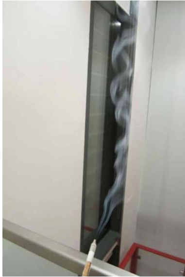
Bild 10: Auftriebsströmung über der Treppe auf der Wohnraumseite (OG)
