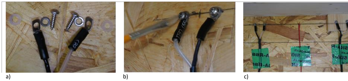
BILD 6-4 FOTOS ZUR BAUWEISE UND ANORDNUNG DER ELEKTRODEN ZUR MATERIALFEUCHTEMESSUNG IN OSB-PLATTEN UND IN FICHTENHOLZ (A, B) SOWIE ZUR LAGE DER ZUGEORDNETEN NTC-FÜHLER ZUR TEMPERATURMESSUNG (C)
