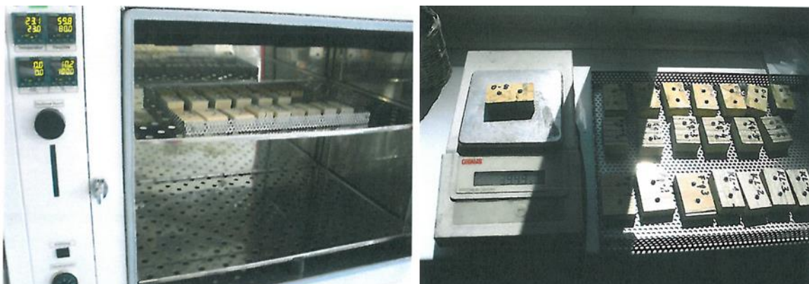
BILD 9-10 LABORMESSUNGEN ZUR BESTIMMUNG DER MATERIALFEUCHTE AUS DEM ELEKTRISCHEN WIDERSTAND BEI VERSCHIEDENEN KLIMABEDINGUNGEN – VORKONDITIONIERUNG IM KLIMASCHRANK UND WÄGUNGEN ZUR ERMITTLUNG DER MATERIALFEUCHTE BEI MASSEKONSTANZ UND ANSCHLIEßENDEN LEITFÄHIGKEITSMESSUNGEN AN DEN EINSCHLAGEELEKTRODEN
