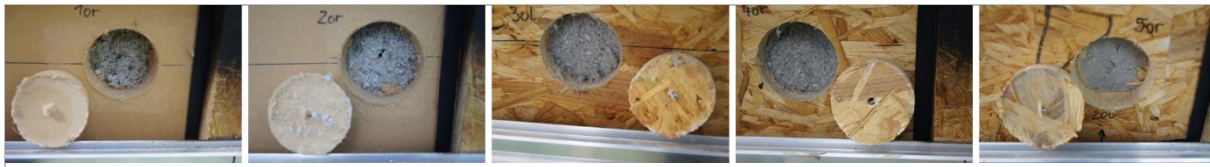
BILD 7-44 FOTOS EINZELNER ENTNAHMEPROBEN IN DEN AUßENSEITIGEN GEFACHBEPLANKUNGEN IN DER NNO-AUßENWAND DES ERDGESCHOSSES BEI DER ÖFFNUNG DER FASSADE AM 27.04.2012
