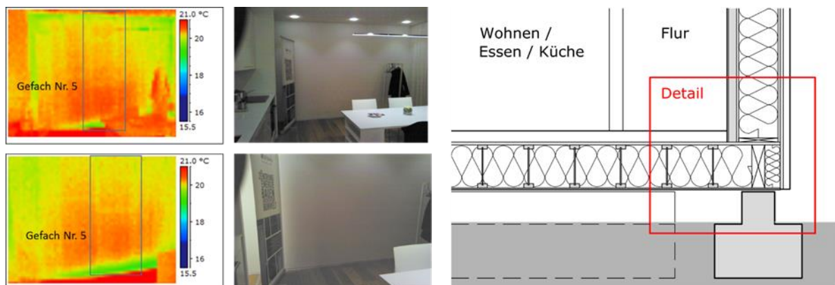
BILD 7-1 IR-THERMOGRAMME UND ZUGEORDNETE FOTOS VON DER NNO-AUßENWAND IM ERDGESCHOSS BEI NATÜRLICHEM LUFTDRUCK IM GEBÄUDE MIT KENNZEICHNUNG VON GEFACH 5 MIT MESSFÜHLERN
