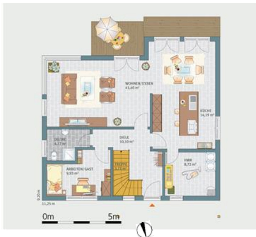
Bild 2: Erdgeschossgrundriss des Effizienzhauses Plus VIO 400 FingerHaus.
