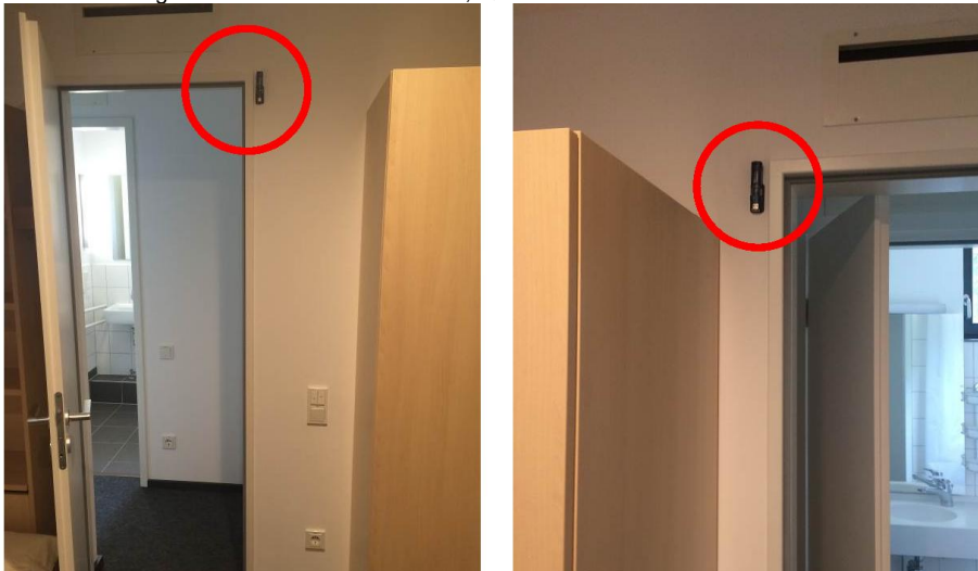
Abb. 18 Datenlogger zur Messung der Temperatur und Raumlufffeuchte in Zimmer Süd (links) und Zimmer Nord (rechts) der Schülerwohnung im EG auf Höhe von 210 cm, Quelle: LBIH
