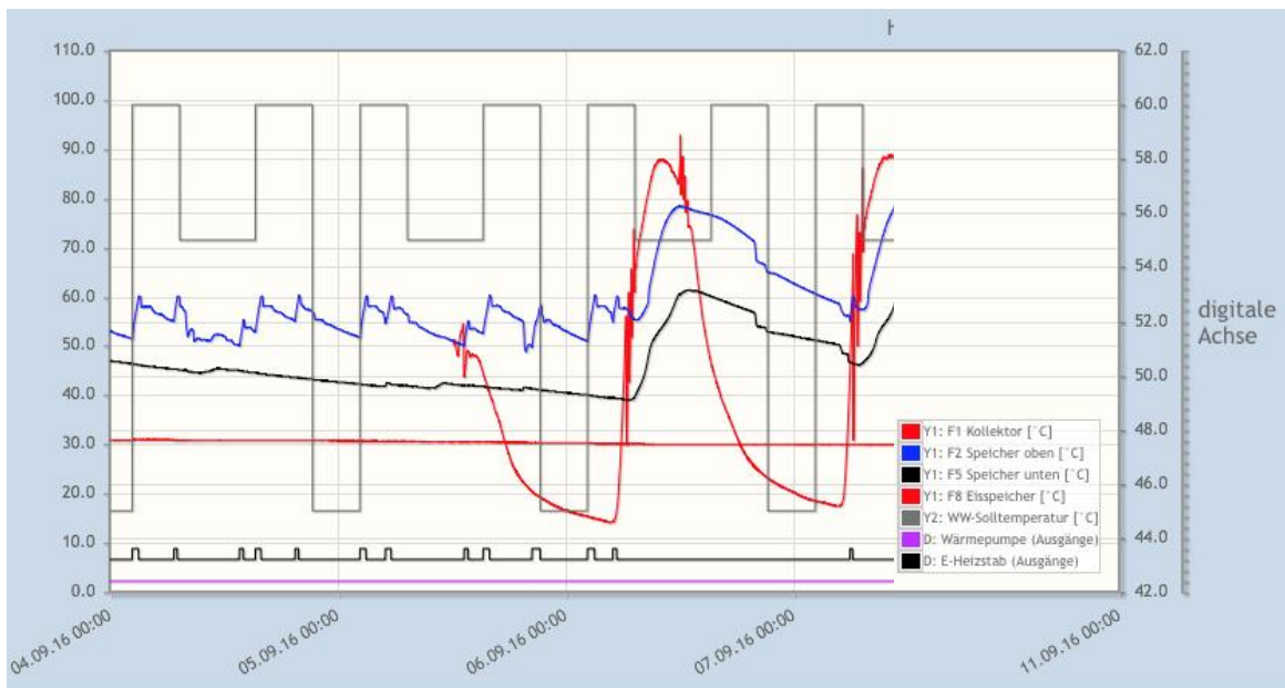
Abb. 34 Heizstab Laufzeit (04.09. - 07.09.2016), Quelle: CONSOLAR
