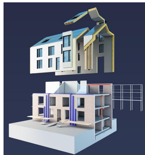
Effizienzhaus Plus vorgefertigte Fassaden- und Dachelemente
