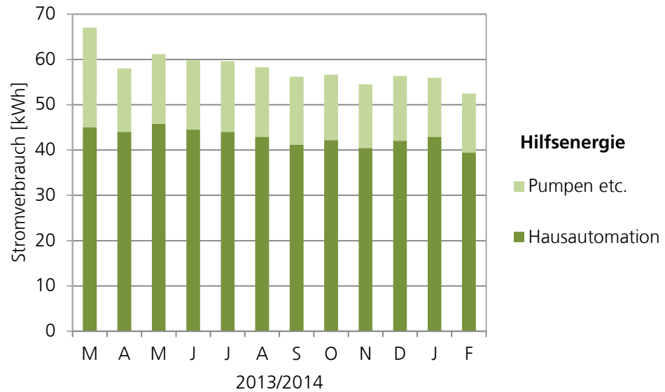
Bild 22: Stromverbrauch Hilfsenergie im Messzeitraum März 2013 bis Februar 2014.
